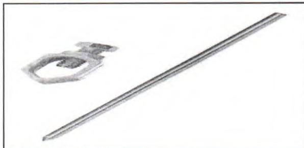
Haste para aterramento tipo copperweld, núcleo em aço (SAE 1020), revestimento em camada de cobre mínima de 0,254mm (10 MILS), formato cilíndrica com extremidade pontiaguda, tamanho 5/8" x 2,4m, conforme NBR 1357 - HASTE DE ATERRAMENTO AÇO COBREADA E ACESSÓRIOS.
